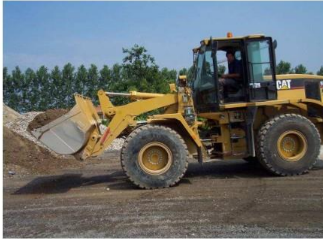
Bom yukarı kaldırıldığında açı pozitif yönde artmalıdır
